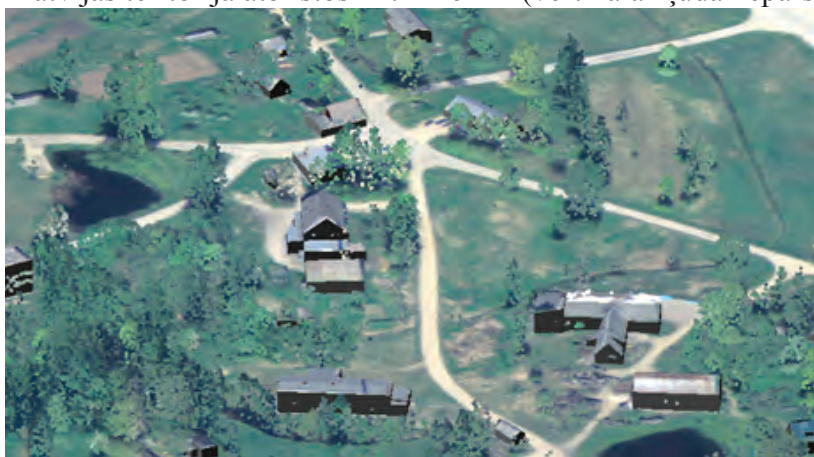
No lāzerskenēšanas datiem un ortofotokartes sagatavots apvidus trīsdimensiju attēls
